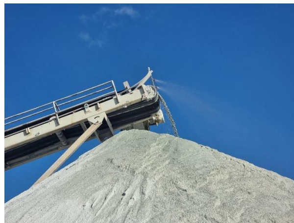
รูปที่ 2-7 (ต่อ) การสเปรย์น้ำที่ปลายสายพานลำเลียงหิน
