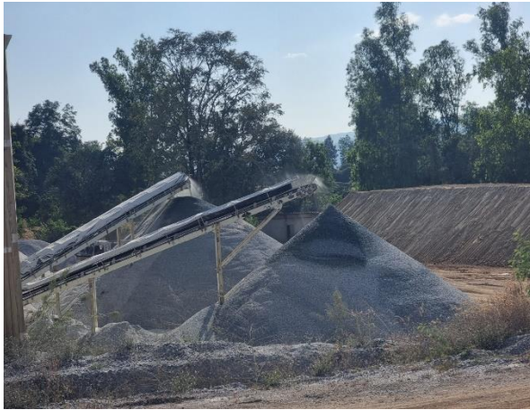
รูปที่ 2-7 (ต่อ) การปิดคลุมสายพานลำเลียง
