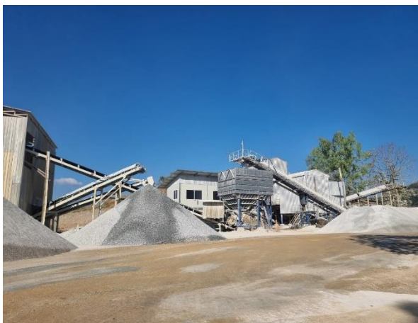
รูปที่ 2-7 โรงโมหินที่ทำตามประกาศกรมอุตสาหกรรมพื้นฐานและการเหมืองแร่ของโครงการ
